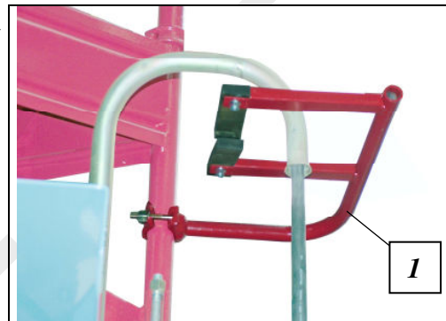
Рис. 29 Кабелепровод для волочащегося кабеля
